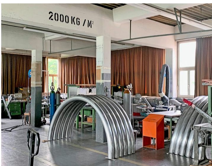
Die Mitarbeitenden der Metallbaufirma Emil Meier in Adliswil stellten in Handarbeit Aluminiumisolatoren für die Elektroindustrie her. Foto: PD
